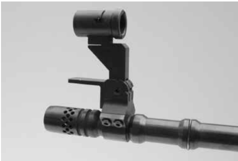
Bild 10: Kornträger als Visierverlängerung (Laufmontage), diverse Fabrikate
