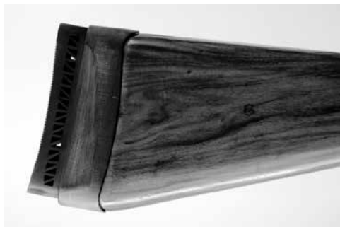
Figure 22: Sabot de crosse 50 mm pour mousqueton 31
