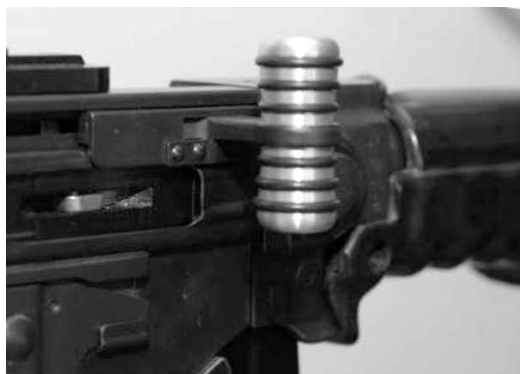
Figura 18: Leva d'armamento anatomica per F ass 57
