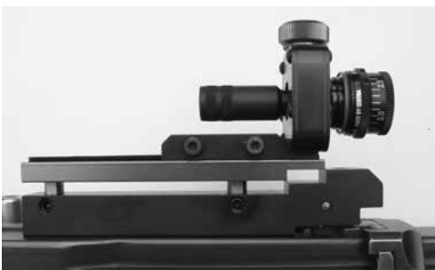
Bild 12: Dioptrträger zu Stgw 57 zur Aufnahme schussfester Diopfer, diverse Fabrikate
