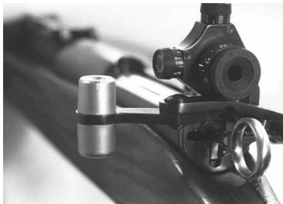
Figure 21: Verrou à gauche pour mousqueton 31
