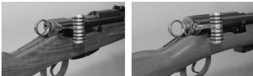
Bild 23: Riegelgriff anatomisch zu Karabiner und Langgewehr
