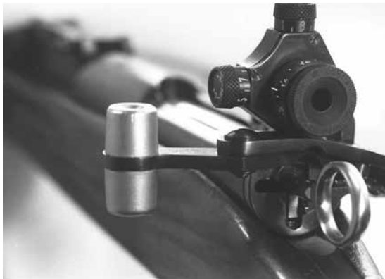
Bild 21: Linksriegel zu Karabiner 31
