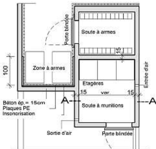
Construction d'un magasin à munitions (vue en plan et coupe)
